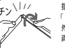
左図のようにフレームの端に指をかけ外側に回転させると「パチン」と音がしてロックが外れます。両端を外してから開きます。
